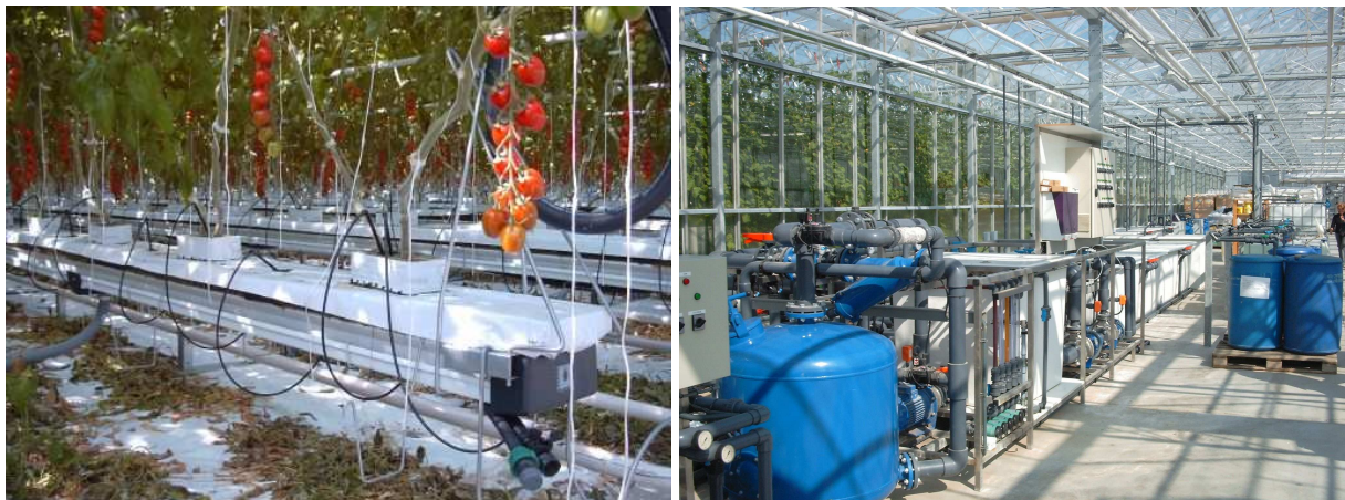
Bild: Hors-Sol-Paradeiser: Über die Schläuche werden Wasser und Chemikalien zugeführt. Rechts: Chemieverorgung.
