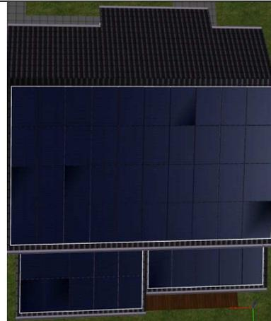
Rund 115m<sup>2</sup> Dachfläche (vgl. bebauter Fläche: 121m<sup>2</sup>) sind beim „SUN“-Gebäude mit einem Neigungswinkel von 25° nach Süden orientiert und somit optimal für die Solarenergieerzeugung geeignet.
