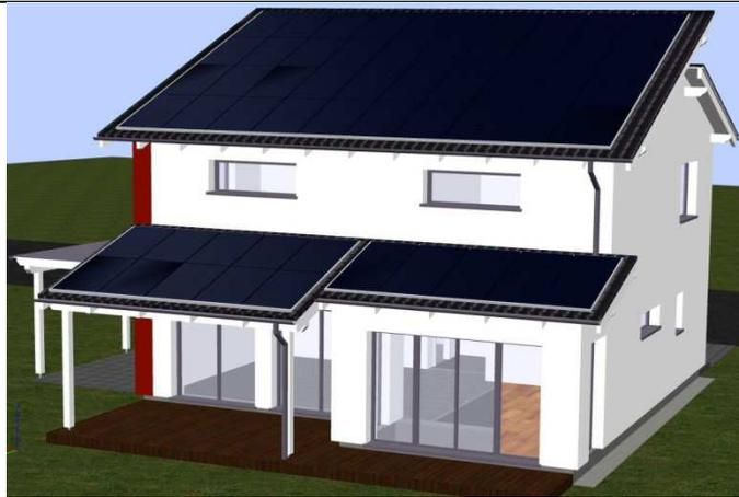
Abbildung 3: Das versetzte Pultdach des „SUN“-Gebäudes hat eine größere Süddachfläche als ein herkömmliches Satteldach. Gemeinsam mit den Pultdachflächen über dem Wohnzimmer und der Terrasse ergibt einen jährliches Solarenergiepotenzial, das größer ist als der Bedarf von Heizung, Warmwasserbereitung Haushaltsstrom und zukünftige Elektrofahrzeuge zusammen. [1]
